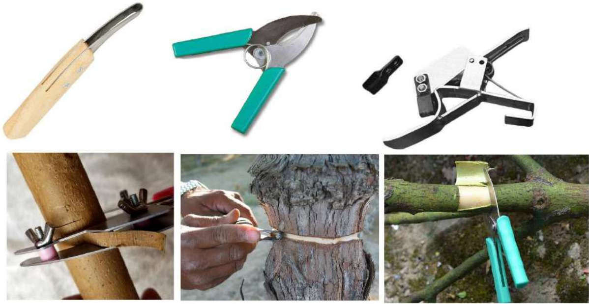
Şekil 1. Bilezik alma işleminde kullanılan bazı aletler (üstte) ve değişik bitkilerde bilezik alma uygulamaları
